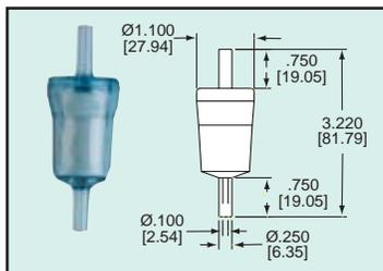
使用 F195 型一次性管线过滤器可以除去气流中 **99.99%** 的有害微粒。密封的碳纤维滤芯可以滤去小至 0.1 微米的微粒。过滤器是一次性的。当它变脏时只需从管道上取下扔掉即可。通过透明的尼龙外壳可以很容易判断是否需要更换过滤器。
