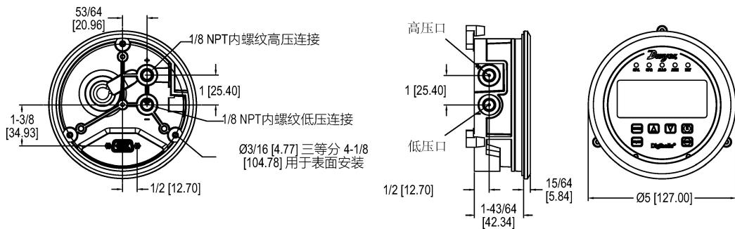
DHC系列Digihelic®差压控制器是三项功能的组合仪表，包括数显差压表、继电器控制输出差压开关、电流和电压信号输出的差压变送器。三合一组合可以精简库存，节约安装时间和成本。DHC系列Digihelic®差压控制器最适用于差压测量，风速测量，风量测量，可选多种工程单位，单向双向组合量程。在极低差压测量时能达到1.5%的精度，超过1英寸水柱量程的仪表能够达到0.5%的精度。可以在现场进行校准，更容易维护和保持其准确性。此外，DHC系列Digihelic®差压控制器带有2个可调死区的单刀双掷继电器开关。使用内置菜单进行配置，可调整4-20mA对应的量程范围、可选的电压信号输出，可选Modbus®或BACnet通讯，使用简易方便，应用广泛。
